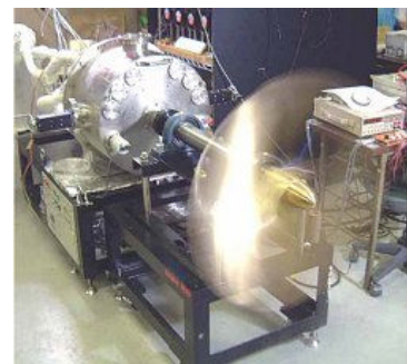
図-6 バルク式超電導電動機の構成と実験中の様子（出典：北野精機ホームページ）
