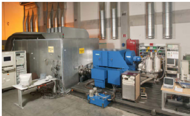
図-4 シーメンス社超電導発電機試験(出典：同社ホームページ)
