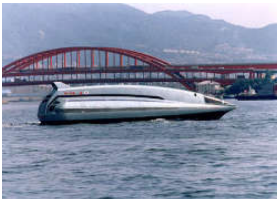
図-2 電磁推進船ヤマトー1 (出典：三菱重工ホームページ)
