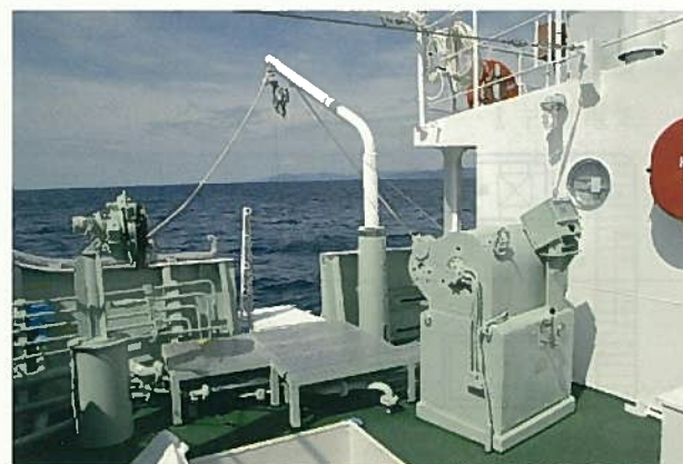
船首ラインローラー・ネットローラー及びブーム
