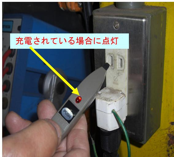
感電事故防止のため、テスターや検電器を使い通電されているか確認したうえで点検をすること。(写真は検電器を使った確認例)
