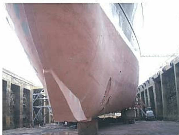
図5 音響センサの取り付け部 日本船に比べて極めて船首側にある。
