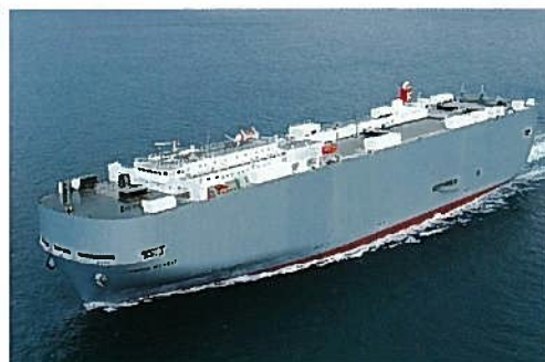
LONDON HIGHWAY 55,600総トン／17,765重量トン／全長199.94m
